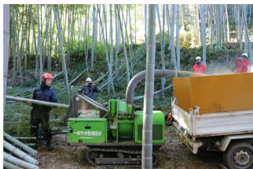
写真：自走式チップパーによるチップ化作業。
