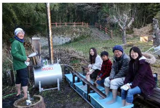
写真2 完成した竹ボイラーによる足湯システム
