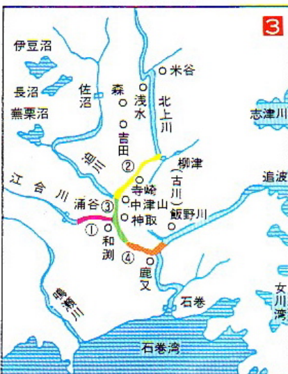
①元和2年江合川と迫川を合流 (1616)(短台地峡の開削) ②元和3年~6年 (1617~1620) 柳津~猪岡短台開削 麻崎村小麻に締切堤防を築く ③神取山を迂回する河道の掘削 (人口狭窄部をつくる)
